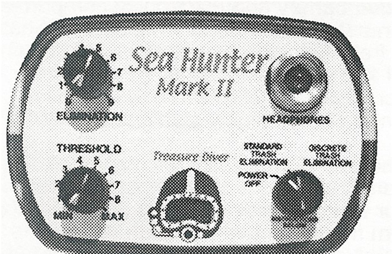
**POWER** : tournez le potentiomètre vers la droite pour le mettre en fonction et choisissez l'un des deux modes de détection. Un test batterie se fera entendre à chaque mise en fonction du détecteur.
