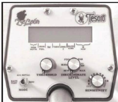
Tournez le bouton SENSITIVITY dans le sens des aiguilles d'une montre, passez le clic jusqu'à la position 2 ou 3. Vous devriez entendre un signal sonore prolongé qui va en s'atténuant.
