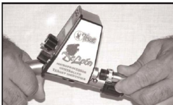
8) Connectez la prise mâle du cordon dans le connecteur femelle du boîtier de contrôle et serrez l'écrou de câble. Il reste à ajuster la longueur de la canne à votre taille (\*) et c'est fini !
