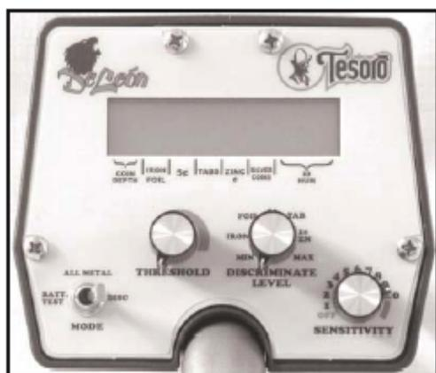
Le bouton sensibilité est gradué de 1 à 10 avec une zone supplémentaire appelée zone de boost qui, lorsqu'elle est utilisée, augmente la puissance des amplis opérationnels jusqu'au point de surcharge, rendant l'appareil instable, ce qui nécessite à ce point une réduction du réglage pour retrouver un confort de fonctionnement normal. Les réglages dans la zone de boost sont faisables sur terrains peu minéralisés et entraînent une meilleure pénétration et une précision accrue dans le sol.
