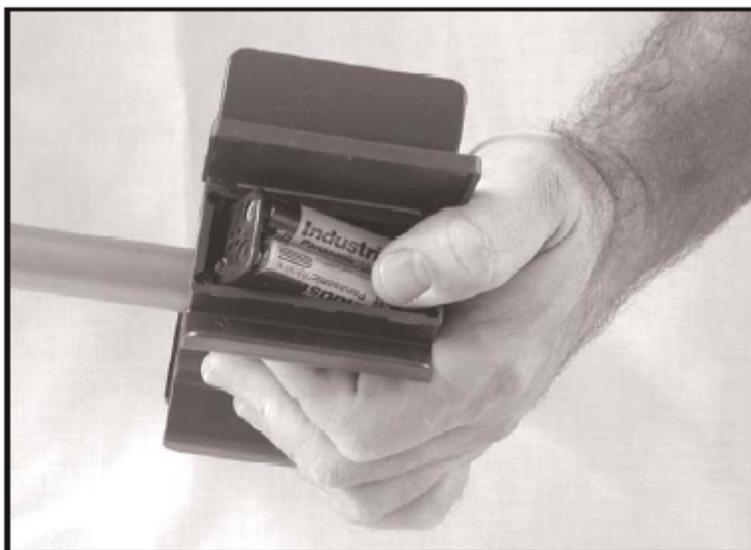
En remplaçant le support, notez la position des clips à ressort à l'intérieur du boîtier et assurez-vous que les contacts des batteries touchent bien les lamelles ressorts. Insérez en premier le côté avec les contacteurs et appuyez sur le bord gauche du support de batteries pour le repositionner. Fermez la porte du compartiment.
