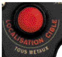
C'est un interrupteur à deux positions qui se situe sur la face avant du boîtier. La position haute correspond au mode "recherche silencieuse dynamique sans discrimination". Pour obtenir un son il vous faudra balayer constamment (principe du mode dynamique). Sur la position LOCALISATION (PINPOINT), l'appareil fonctionnera en mode statique. Il ne sera alors plus besoin d'exercer un balayage constant.
