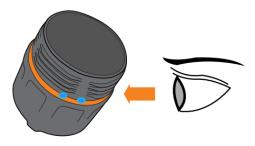
Surveillez le joint d'étanchéité régulièrement et retirez les débris observés sur le pas de vis. Même un seul grain de sable peut être à l'origine d'une inflitration.
