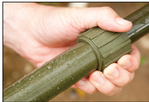
Tourner les écrous de la canne et les rincer à nouveau pour s'assurer que toutes les particules ont été retirées.
